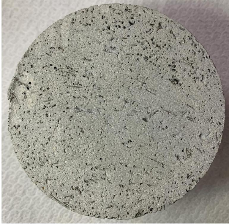
圖 4.2 鋼纖維添加量 1.0%之混凝土試體剖面照片(石英砂比例 2.0)
