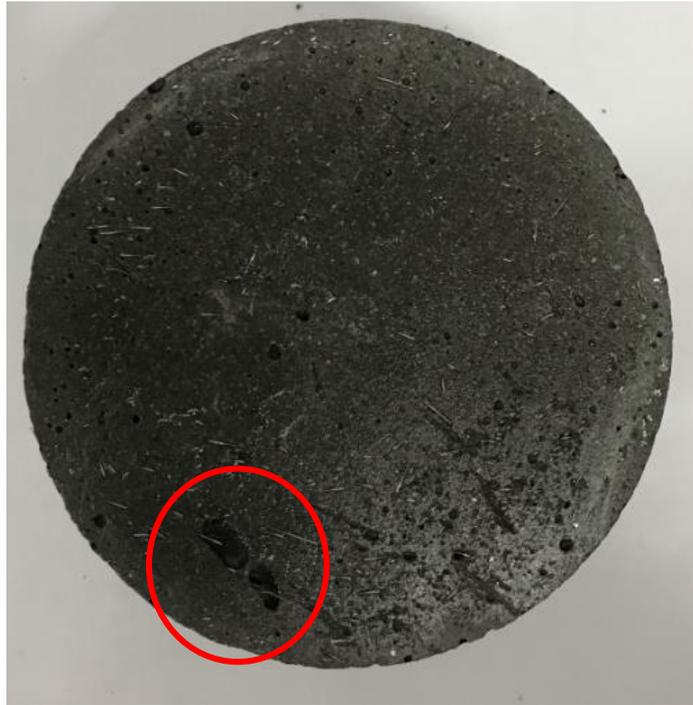
圖 4.13 搗棒搗實之試體剖面狀況
