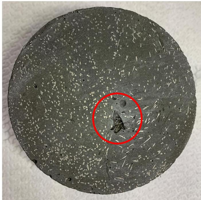
圖 4.3 鋼纖維添加量 2.0%之混凝土試體剖面照片(石英砂比例 1.2)
