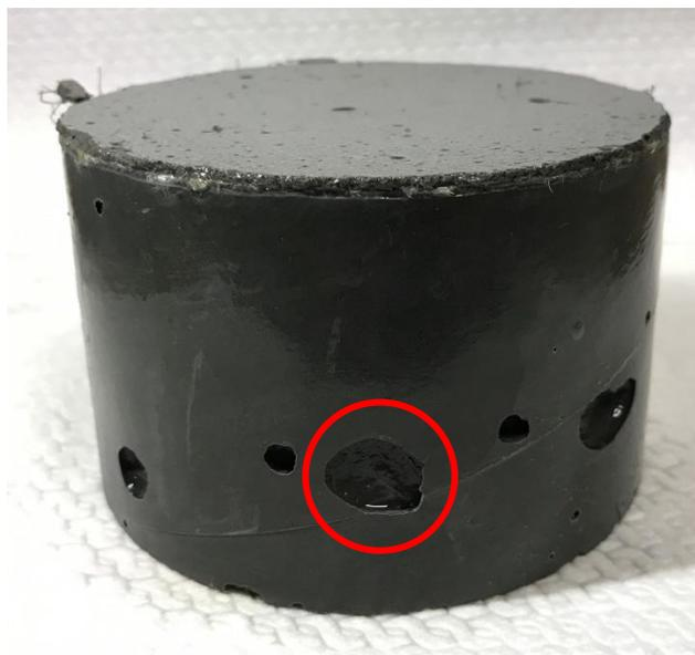
圖 4.14 震動 30 秒之試體側面狀況
