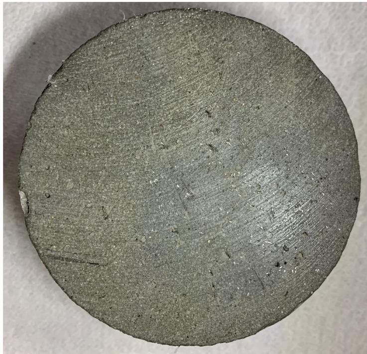
圖 4.8 減水劑用量 1.3%之混凝土剖面(石英砂比例 1.2)
