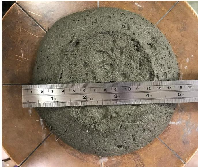
圖 4.11 流度試驗結果
