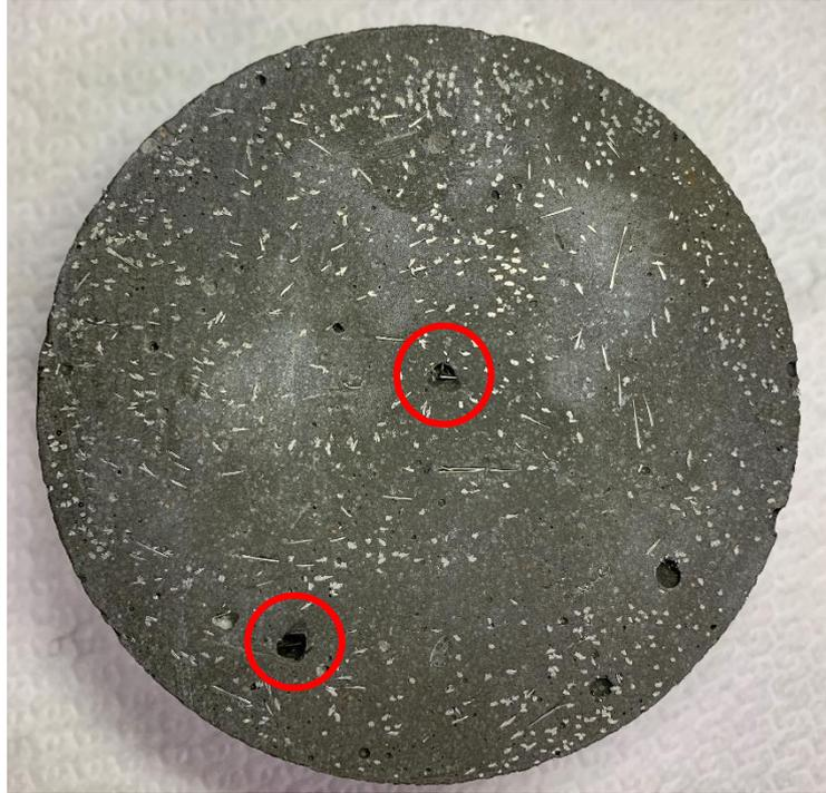
圖 4.4 鋼纖維添加量 1.5%之混凝土試體剖面照片(石英砂比例 1.2)
