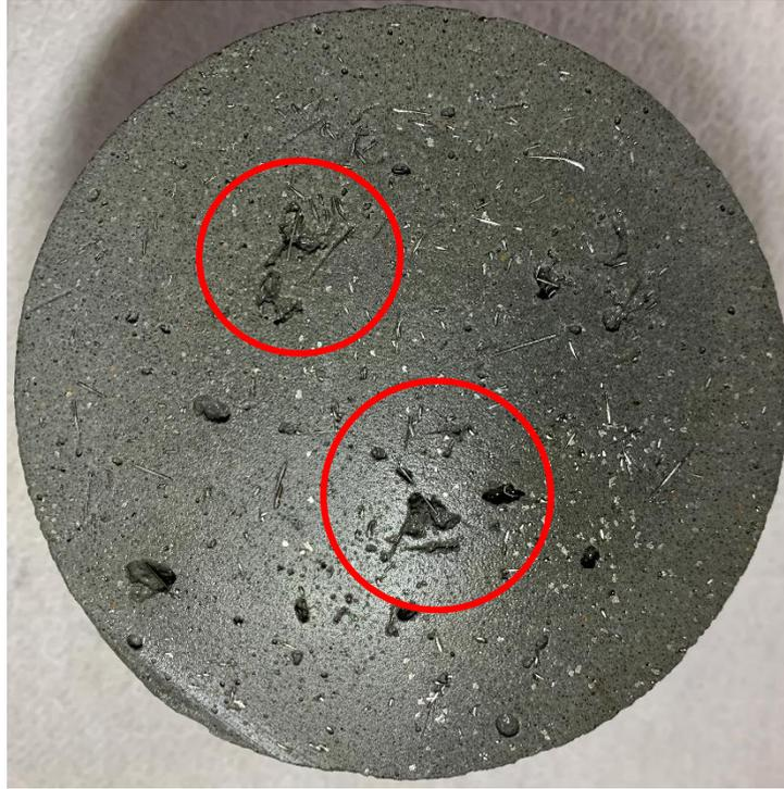
圖 4.9 減水劑用量 0.4%之混凝土剖面(石英砂比例 1.2)
