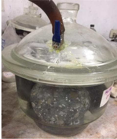
圖 3.7 孔隙率試驗抽真空設備
