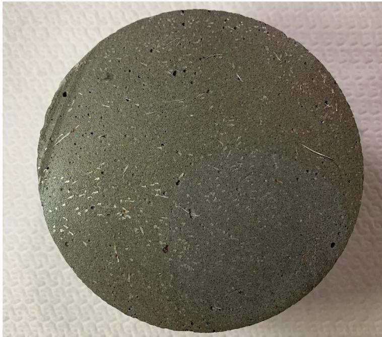
圖 4.5 鋼纖維添加量 1.0%之混凝土試體剖面照片(石英砂比例 1.2)
