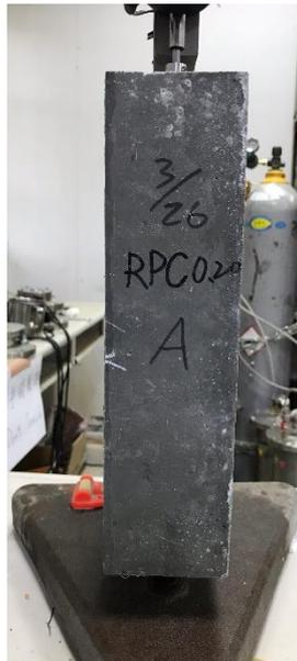
圖 3.9 混凝土乾縮試體
