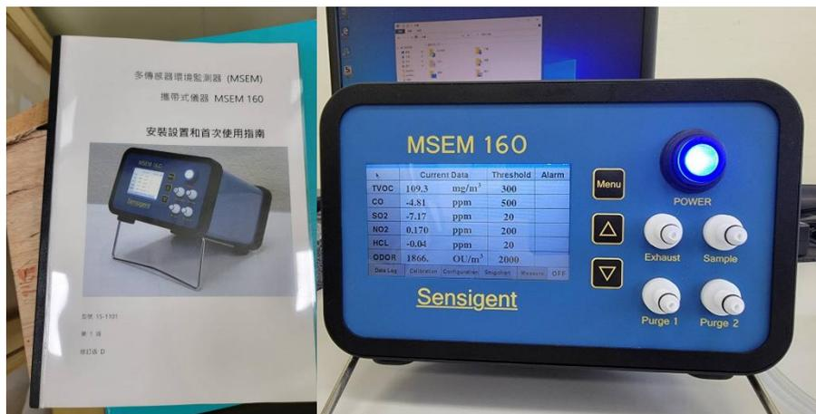
圖 23、多傳感器環境監測儀 (MSEM)說明書與操作介面
