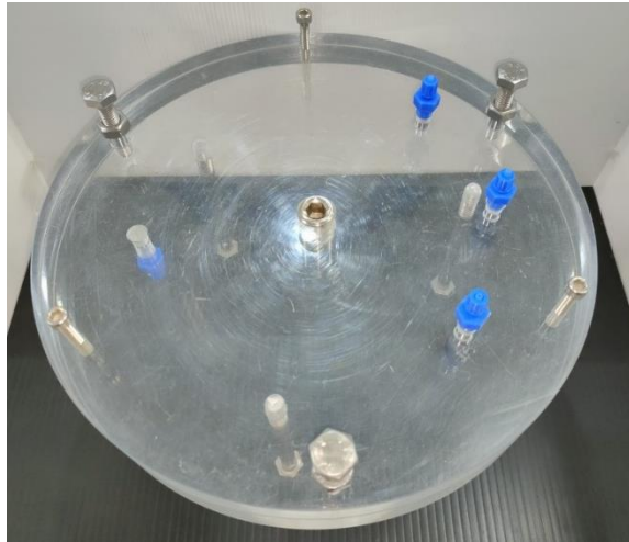
圖 3.7 模擬裂隙透明壓克力模具
