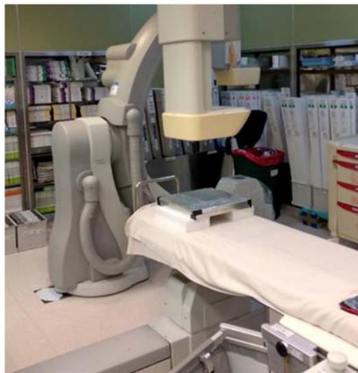
圖 5-1 進行不同廠牌側向管球品保項目可行性之測試，發現心導管 X 光機的側向管球普遍都可以旋轉 180 度，然後依照前像管球的品保作業方法，完成測試。
