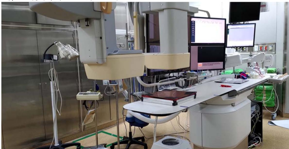
圖 5-38 進行側面管球品保測試，可以將側面管球旋轉 90 度，以方便進行測量。
