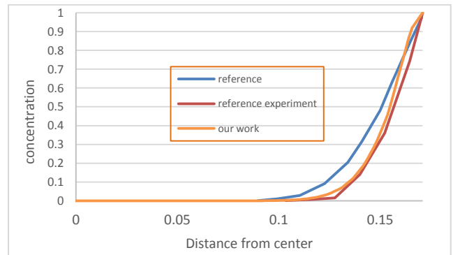
圖 III-6 鉍離子濃度隨距離改變之變化(在 0.61 公尺高處)
