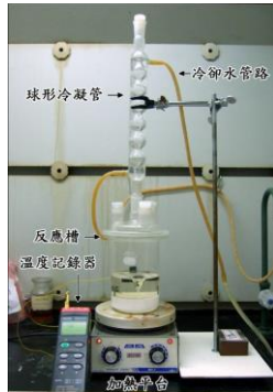
圖 1、惠氏腐蝕實驗設置
