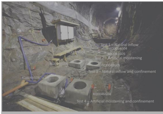
圖 II.2-1 Ä SPÖ 實驗室進行 4 組 THM 對照試驗
