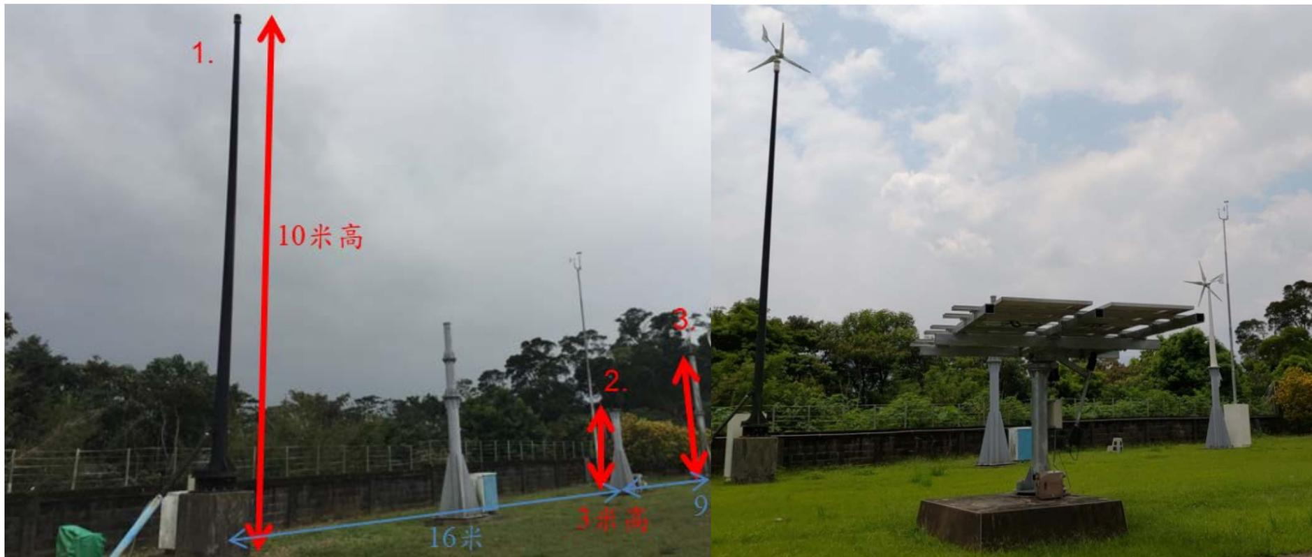
(a)編號 1 與編號 3 為三葉式風機，編號 2 為五葉式風機
