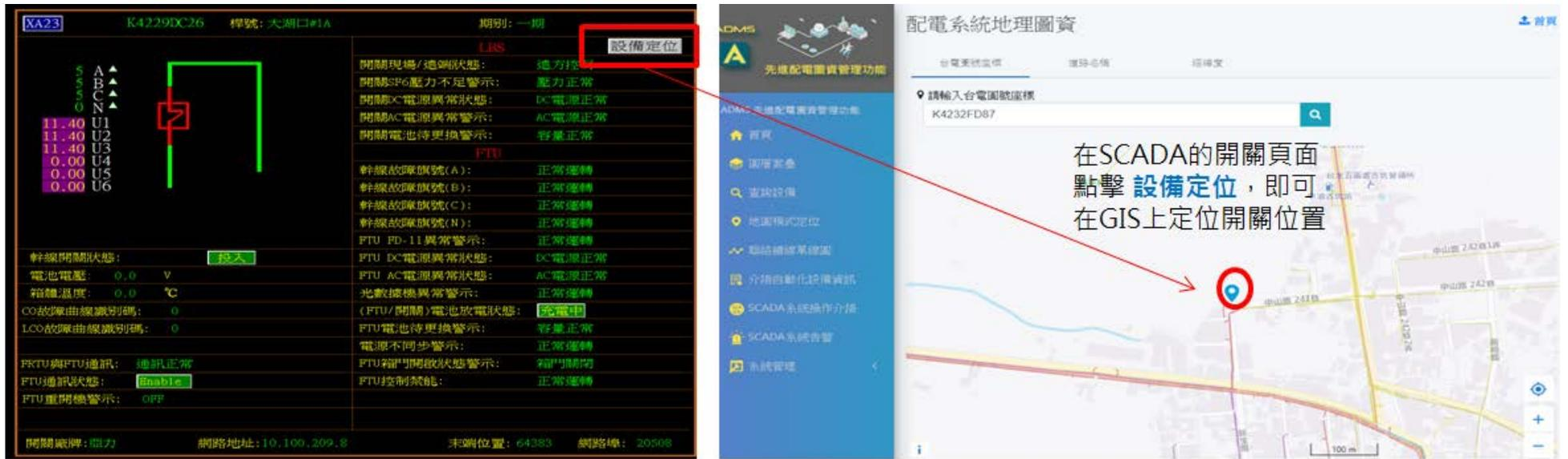
圖 2 SCADA 及 GIS 跨系統間互動定位功能
