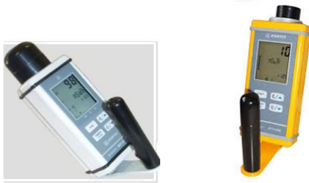
圖 1. 手持式塑膠閃爍偵檢器 ATOMTEX AT1121(左)、NaI(Tl)閃爍偵檢器 AT1103M(右)。
