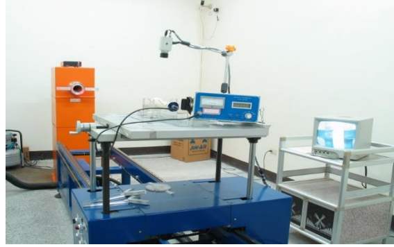
圖 4. 清華大學原科中心之二級標準輻射偵檢儀校正場(使用 ^{137}\text{Cs} 輻射源)
