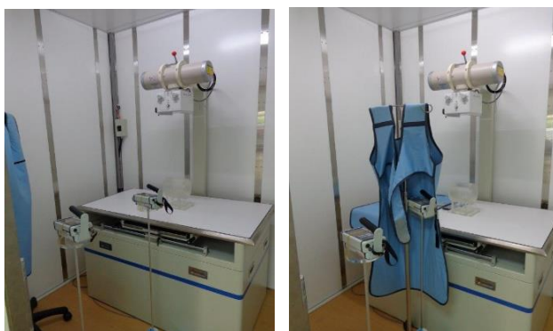
圖9. 考量動物用X光檢查儀協助者在檢查室內協助動物擺位照相的情形，以手持式偵檢器測量，評估其有穿(右)及無穿(左)鉛屏蔽衣之居佔位置劑量(率)示意圖
