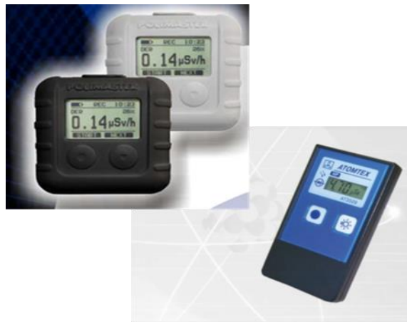
圖 2. 可測累積劑量與劑量率之電子式劑量警報計
