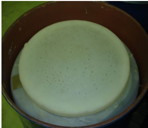
圖 1：整桶樹脂(充填率 96%)
