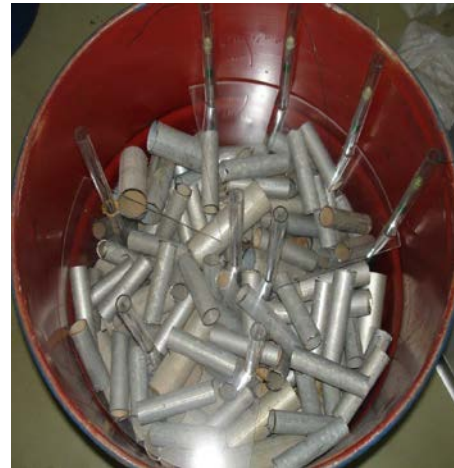
圖 7：金屬桶內射源棒放置偏單邊或集中中心位置
