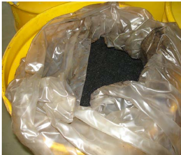
圖 2：整桶過濾器活性碳(充填率 90%)
