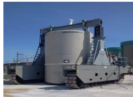
圖 7:Zion 電廠用過燃料乾式護箱
