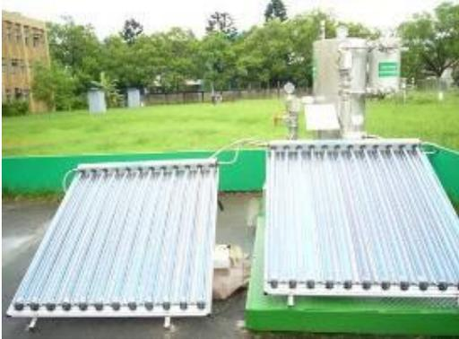
太陽能 U 型真空管集熱器測試平台
