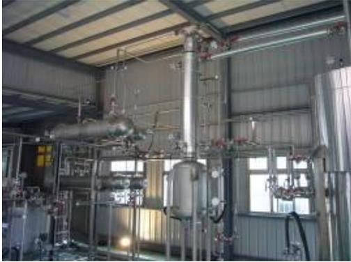
實驗型高導電度廢液蒸發濃縮設備
