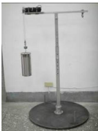
熱室用鈾泥(粉)罐吊車裝置
