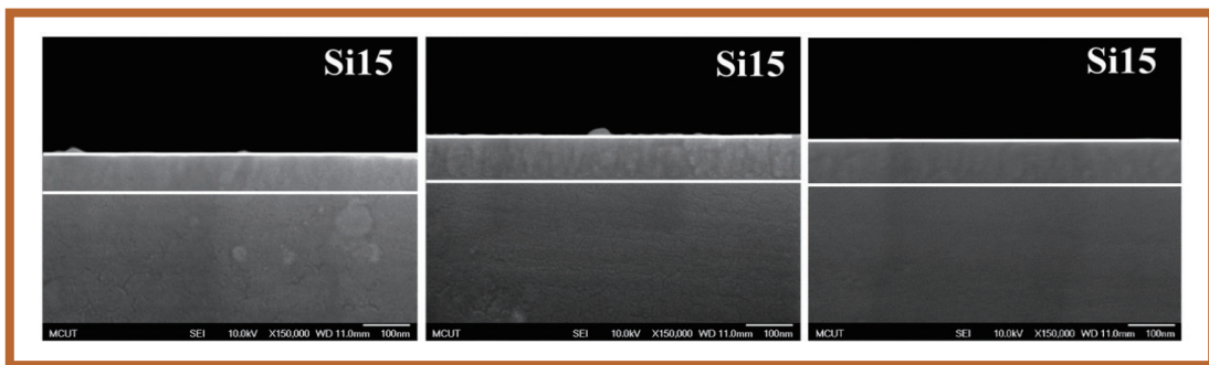
圖 2 單面兩層 \text{TiO}_x/\text{SiO}_x 薄膜的截面微結構。
