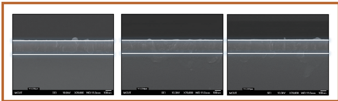
圖 3 單面四層 \text{TiO}_x/\text{SiO}_x/\text{TiO}_x/\text{SiO}_x 薄膜的截面微結構。
