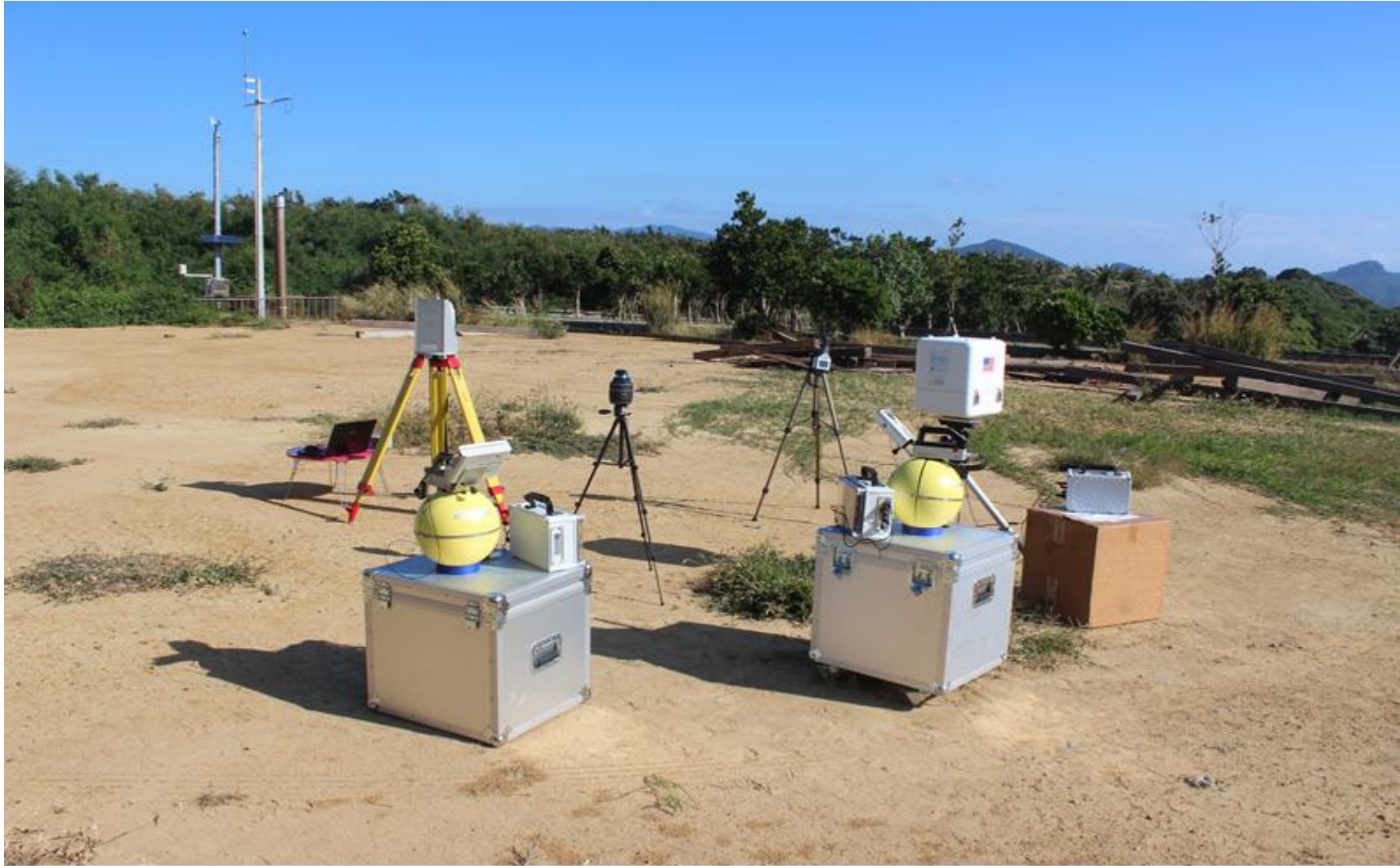
圖 3-3．屏東縣貓鼻頭公園現場環境輻度量
