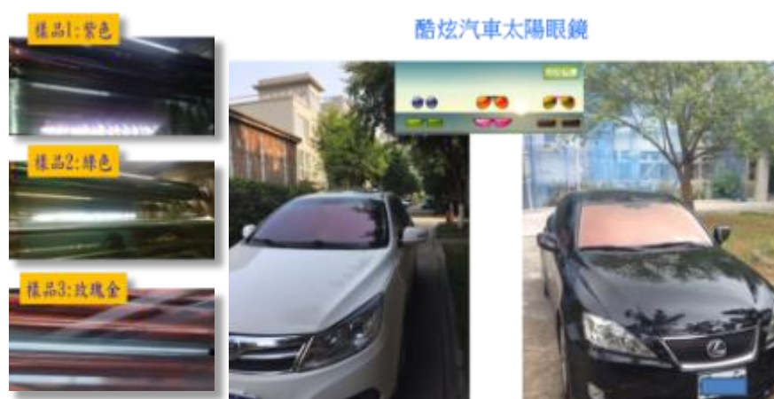
圖 4-3、各色系頂級低熱輻射率膜及實際貼膜應用
