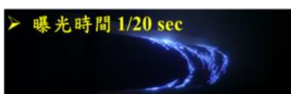
相機拍攝電弧電漿製程中之弧斑影像軌跡
