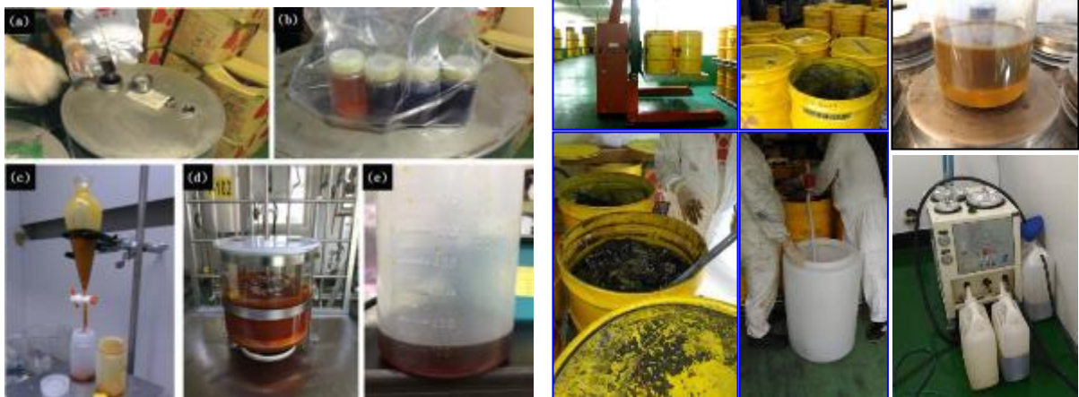
圖 2-21、放射性磷酸三正丁酯處理作業 圖 2-22、放射性含油污泥之處理作業
