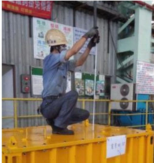
圖 2-38、B-25 容器墜貫穿落測試
