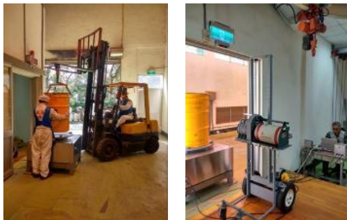
圖 2-42、015B 固化廢棄物桶整桶計測
