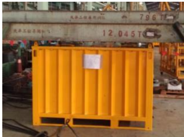
圖 2-39、B-25 容器堆疊測試
