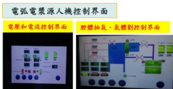
圖 4-6、物理組團隊開發人機介面控制軟體使製程參數調控更精確
