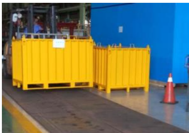
圖 2-37、B-25 容器震動測試
