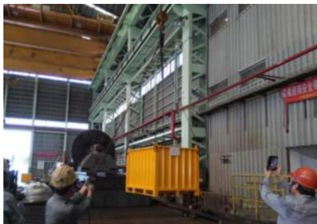
圖 2-36、B-25 容器墜落測試
