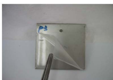
圖 2-2-17、膠體除污劑成膜測試
