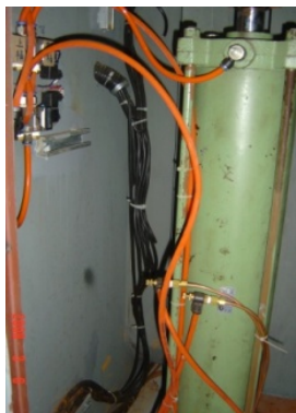
圖 2-2-1、固化設備 55 加侖桶氣壓升降桿空氣管更換前後
