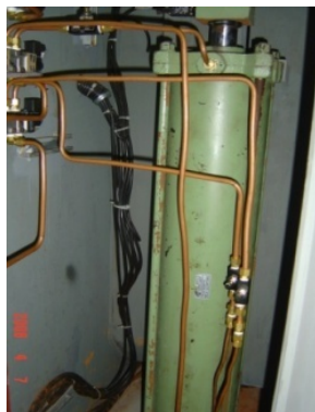
圖 2-2-1、固化設備 55 加侖桶氣壓升降桿空氣管更換前後
