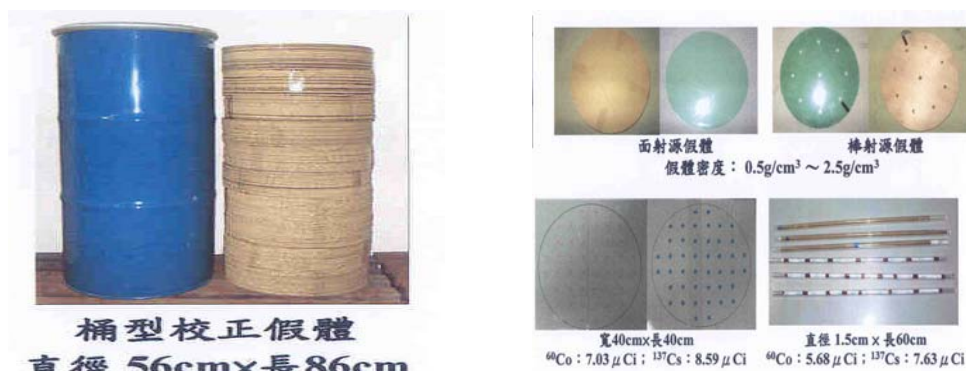
圖1-4-5、桶型校正假體及面/棒狀標準射源
