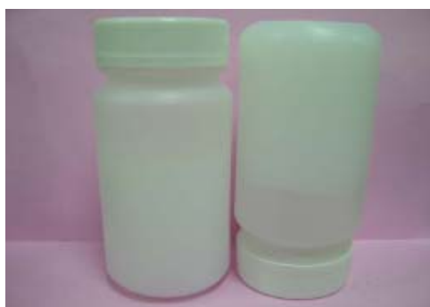
圖 2-2-22、水溶性無機成份膠體除污劑靜置時呈凝膠態攪拌後呈流體態即可使用
