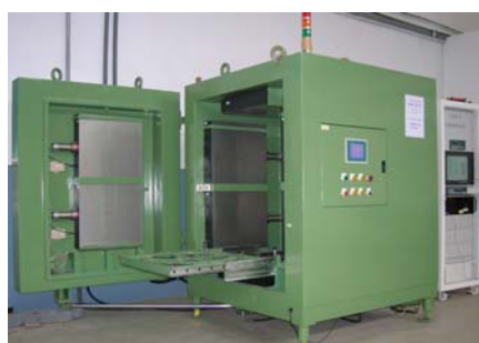
圖 1-4-9、完成場邊高靈敏度污染計測閃爍體桶型計測系統及抽屜式進料 裝置精進
