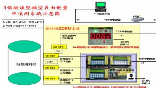
圖 1-4-11、4 偵檢頭型桶型表面劑量率偵測系統製作測試
