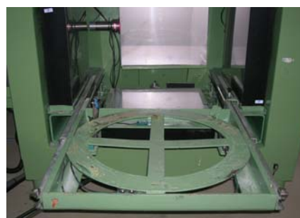
圖 1-4-9、完成場邊高靈敏度污染計測閃爍體桶型計測系統及抽屜式進料 裝置精進
