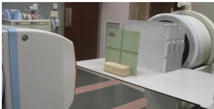
圖 5-22 側面管球光照野評估設置
