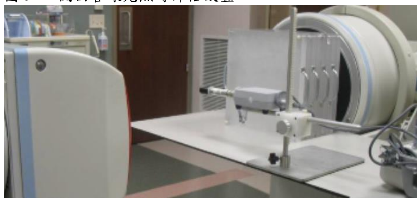
圖 5-23 側面管球劑量評估設置
