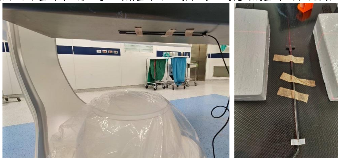
圖 5-1 進行檢查床上與下的參考點累積空氣克馬測試，發現心導管與血管攝影 X 光機的檢查床一般厚度達 2 公分以上，若是將劑量計放置於檢查床下測試，需要特別留意設備固定的方式與劑量計的方向性。
