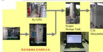
微型渦輪機發電系統圖
