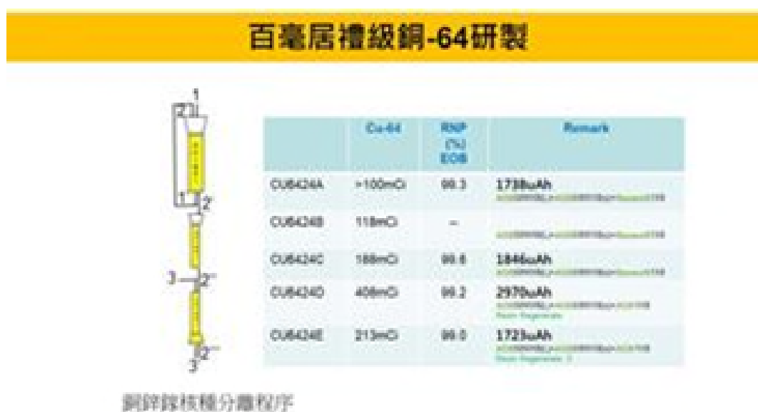
圖 3-2：完成鈮鋇銅鎳核種分離純化研製，鎳核種產率提升 90%以上，銅核種達百毫居禮級活度
