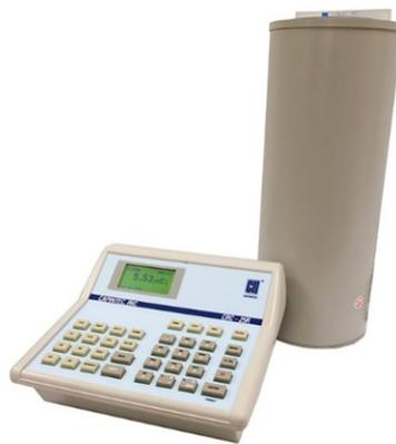
圖 2. 透過井型游離腔 (well-type chamber) 實測射源活度。
