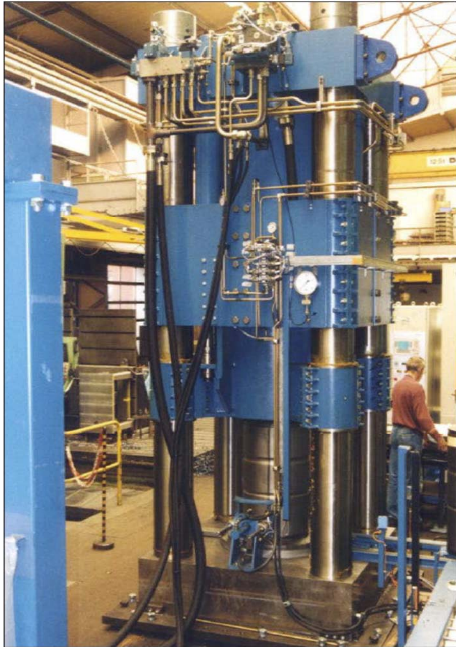
圖 1.3. 10 具 2,000 噸作用力的超級壓實機[3]
