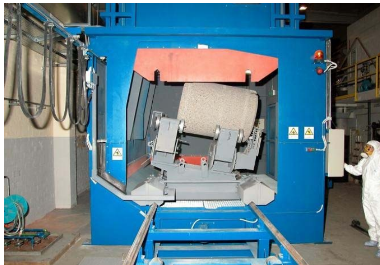
圖 1.2. 3 混凝土容器除污的噴砂設備
