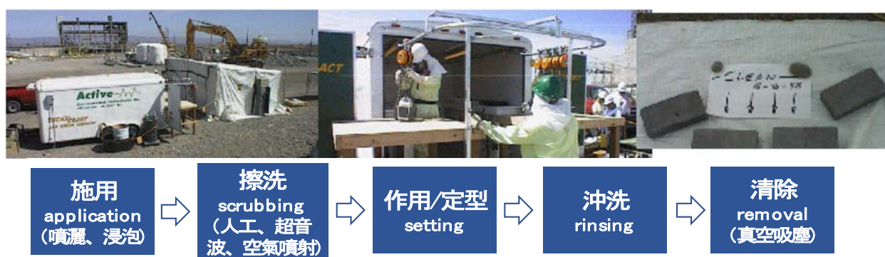
圖 1.1. 5(上) US DOE 於 1998 年報告所示之用於驗證除污鉛磚的 TechXtract®技術設施照片。(下) TechXtract 施用程序摘要。(DOE 1998a[23])
