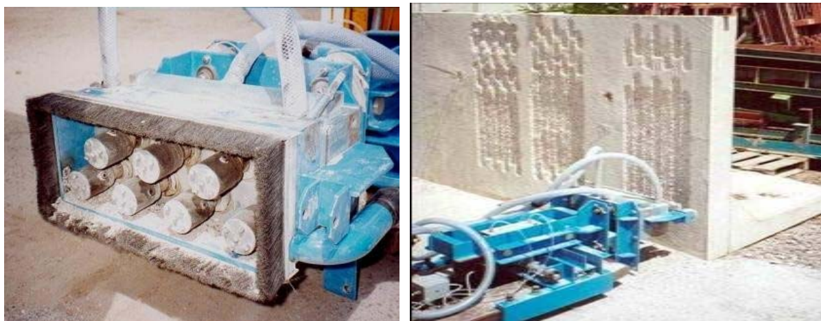
圖 1.2. 14 七頭噴槍(scabblers)及其對混凝土除污之粗糙表面
