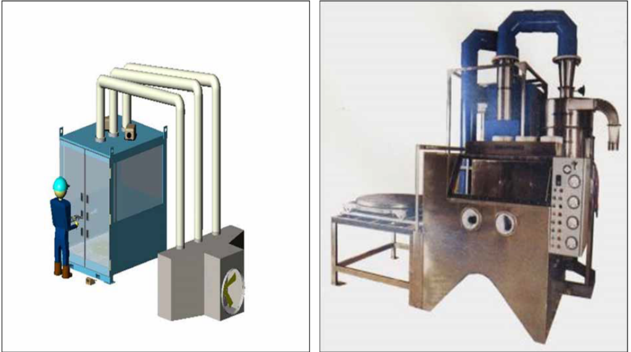
圖 1.2. 2 AQUA-DYNE 公司噴砂儀器示意圖與實際照片
