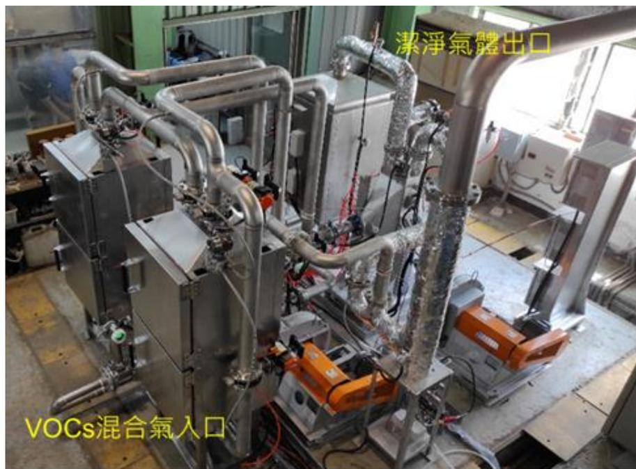
圖 3-2 節能蓄熱式吸附濃縮處理系統實體圖(資料來源:核能研究所)
