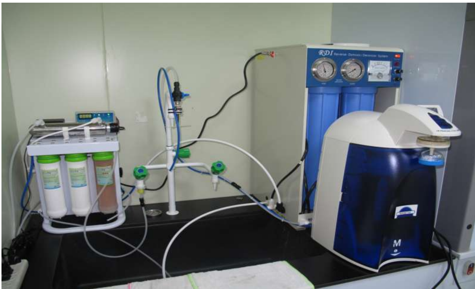
圖 51. 前處理室超純水製造系統
