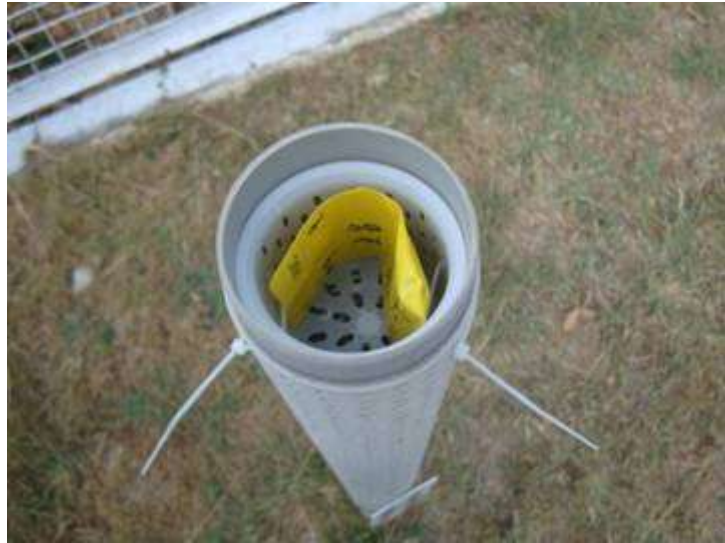
圖 40. 澎湖站佈點管 TLD 佈放圖示
