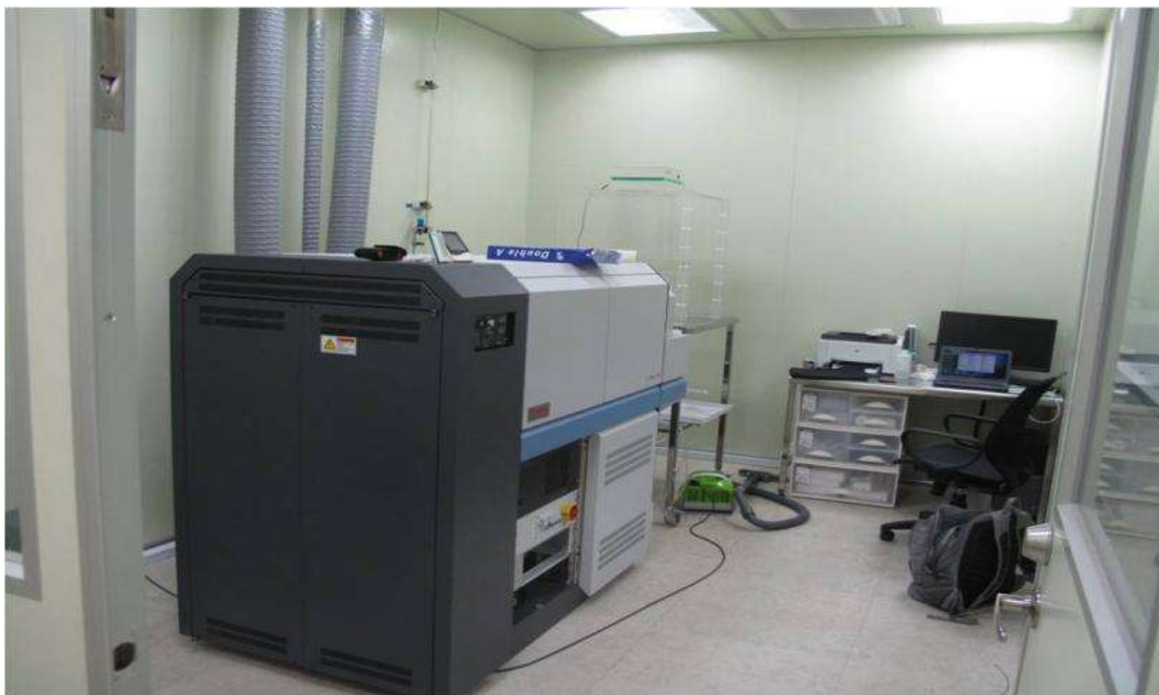
圖 53. 本中心建置之質譜儀器室實景(儀器為高解析感應耦合電漿質譜儀 Element XR)
