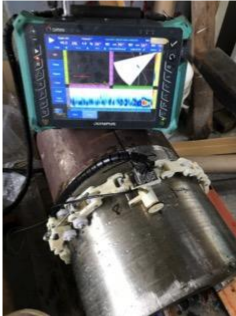
銲接管件之陣列超音波檢測進行方式及探頭架設外觀。
