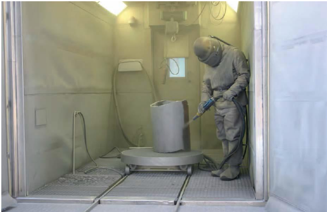
研磨料為砂之噴砂除污作業方式
