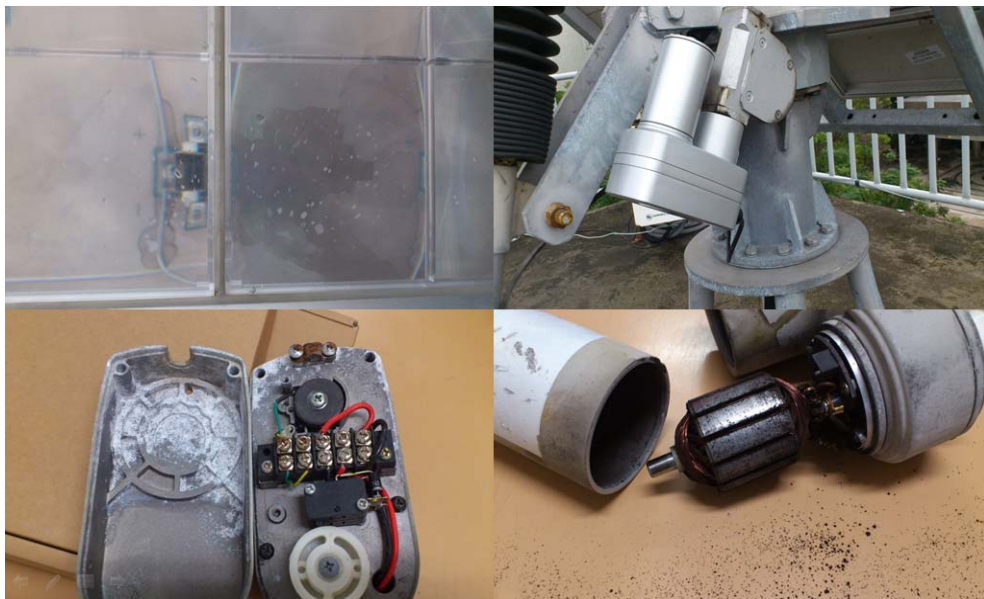
圖 3-18：HCPV 發電系統之支架與傳動裝置鹽霧侵蝕現象
