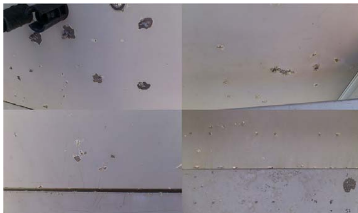
圖 3-17：受測 HCPV 模組背板氧化現況圖(氮化硼)
