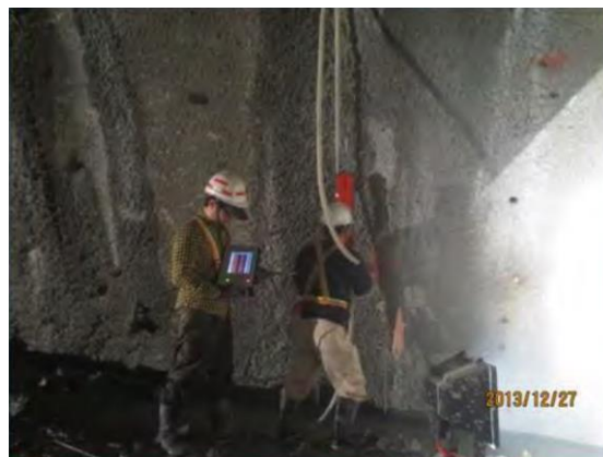
圖3.2-3 蘇花改工程技術論壇-「觀音隧道 新建工程」運用透地雷達檢測 (蘇兆輝，2014)
