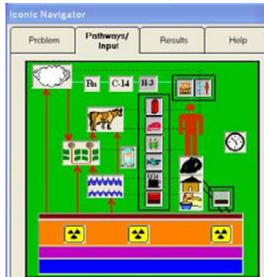
圖 3.3-1 RESRAD 生物圈曝露途徑示意圖
