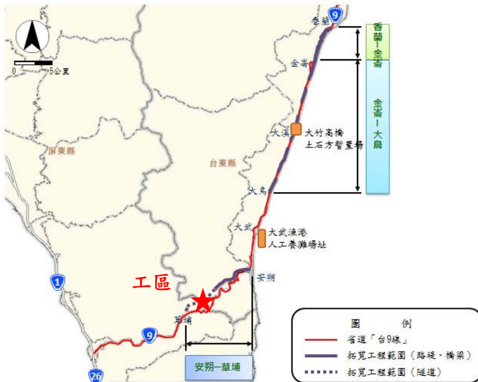
圖2.9台9線拓寬工程示意圖，紫色虛線為草埔隧道，紅色星號為工區相對位置(改自台9線南迴公路改善後續計畫網路資訊平台 https://pweb.ceci.com.tw/vision/intro.aspx )
