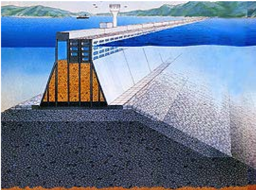
圖 11 釜石灣口防波堤標準斷面圖[5]
