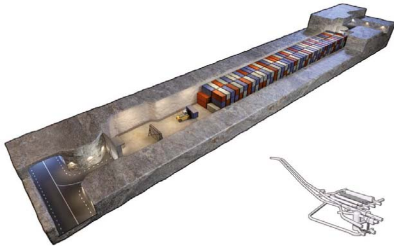
圖 2.23 BLA 低放射性處置坑道於 SFR 1 區域之 1BLA 示意圖。
