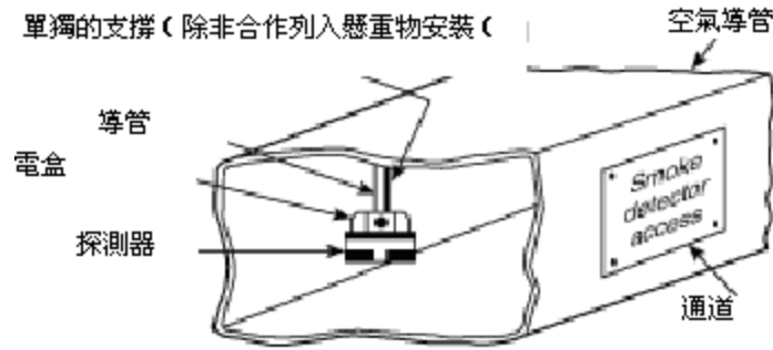
圖 A-2-10.5.2(a) 向下安裝於風管
