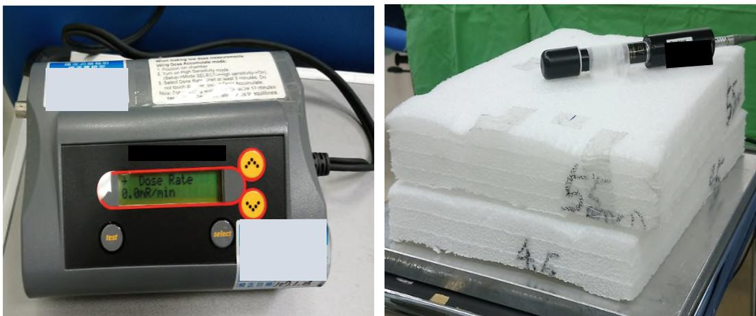
圖 8. 適用透視 X 光系統能量範圍內之游離腔 ( 右 ) 與電量計 ( 左 )。
