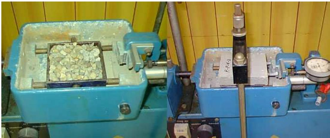
圖 3.17 混凝土沈箱模型試體置於碎石上之直剪試驗[17]
