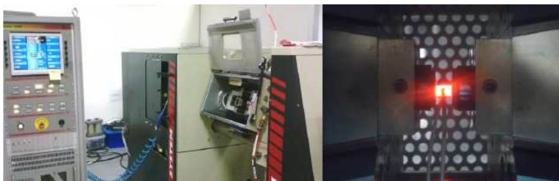
圖四、Gleeble 3500 熱壓測試示意圖
