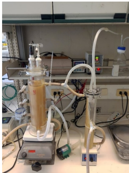
圖5、食品產業廢汙水產製VFAs流程實際照片
