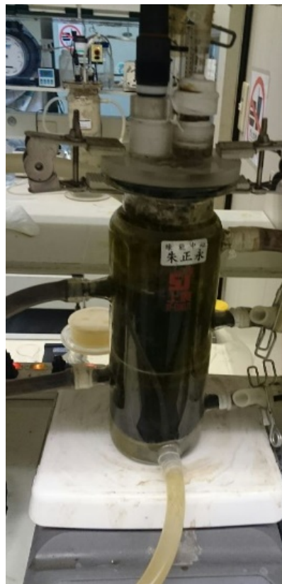
圖 2、豬糞尿混合鳳梨皮渣汙水產 VFAs 反應槽
