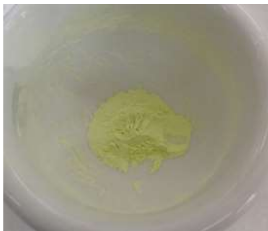
圖 3.4.4.1 27% 莫耳分率的三氧化二鉍及 73% 莫耳分率的三氧化鎢的混合粉末
