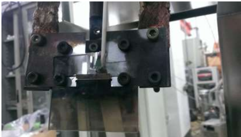
圖 3.4.3.4 試片載台與安裝於載台上之 R-type 電熱偶
