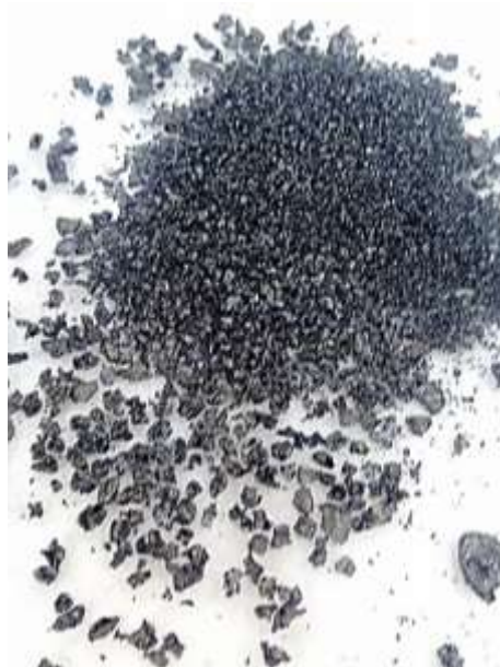
圖 3.4.4.2 27mol% Bi_2O_3 +73mol% WO_3 混合熔體於去離子水中淬冷後熔體固化碎片
