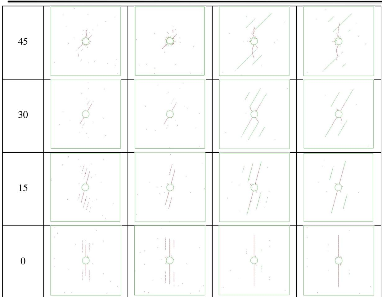
圖4.2-4 本計畫以注水壓力模擬後之裂隙發展
