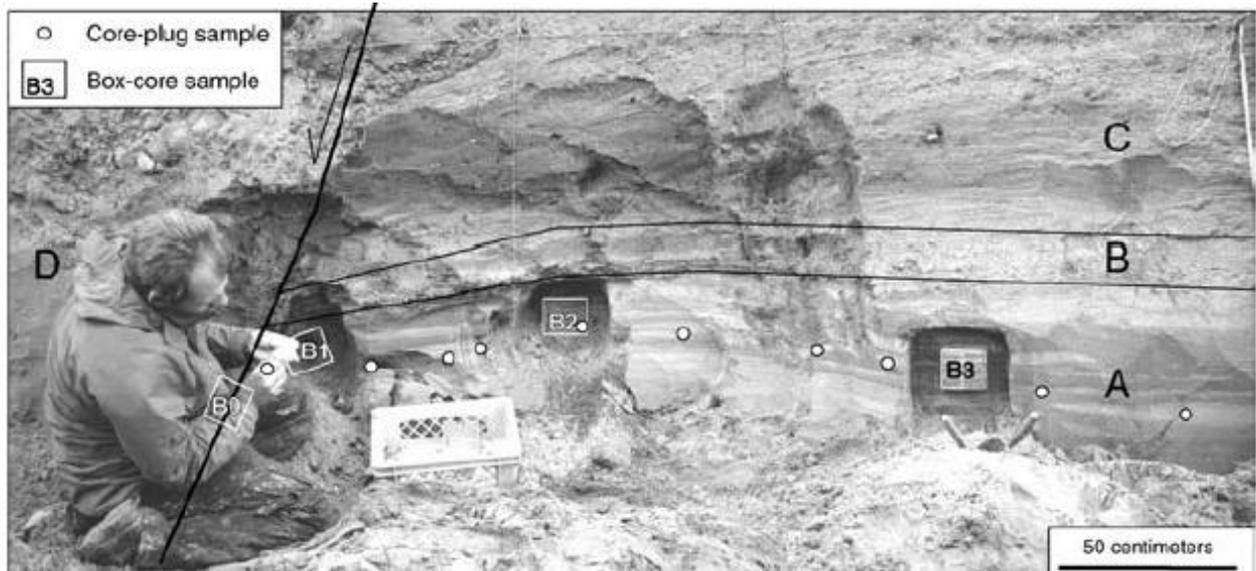
圖 3.5 岩心箱和岩芯柱狀樣本採樣期間，Geleen 斷層的槽溝壁(Bense 等人，2003)
