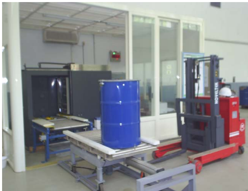
圖 2-2： Canberra-AQ2 固定式加馬活度量測設備
