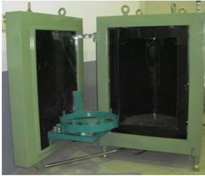
圖 2-5：核研所自製塑膠閃爍體桶形偵檢器
