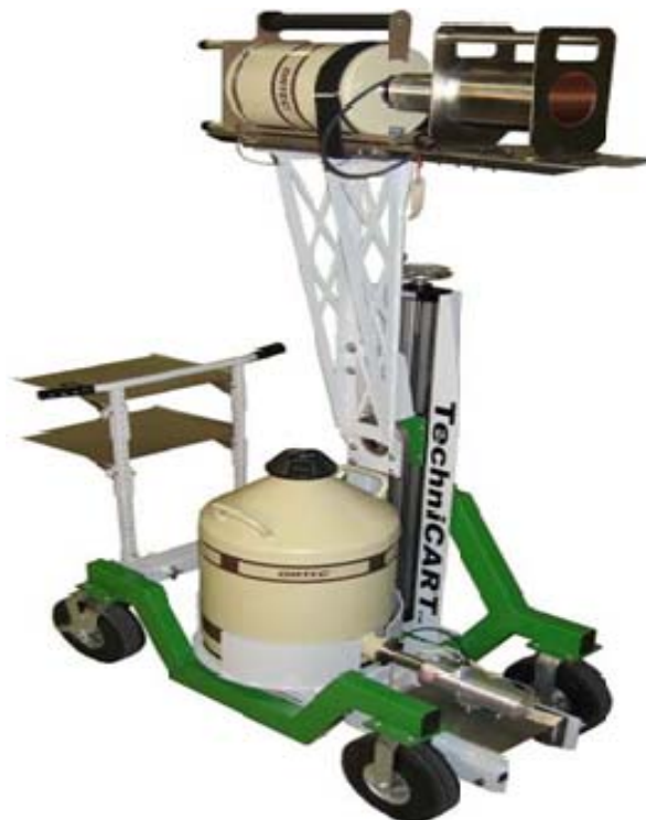
圖 2-4 : ORTEC-ISOCART 移動式純鉻偵檢器
