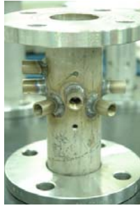
圖 12 新燃燒室加工成品圖 圖 13 新燃燒室 CATIA 設計圖
