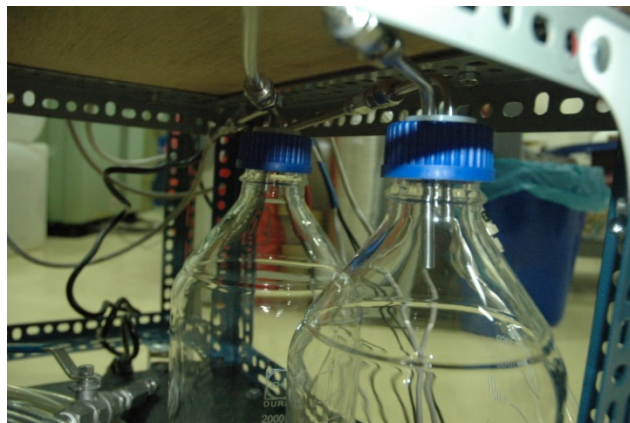
圖 24 液氣分離系統
