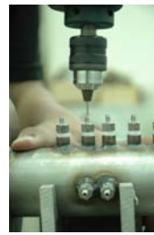
圖 11 管件除去內環窄處
