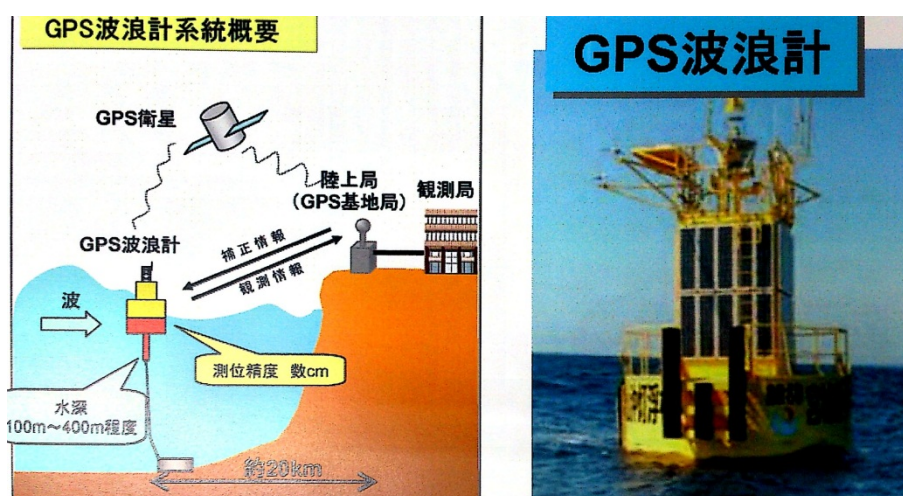
圖 5 GPS 波浪儀系統概要 (資料來源：獨立行政法人 港灣空港技術研究所)
