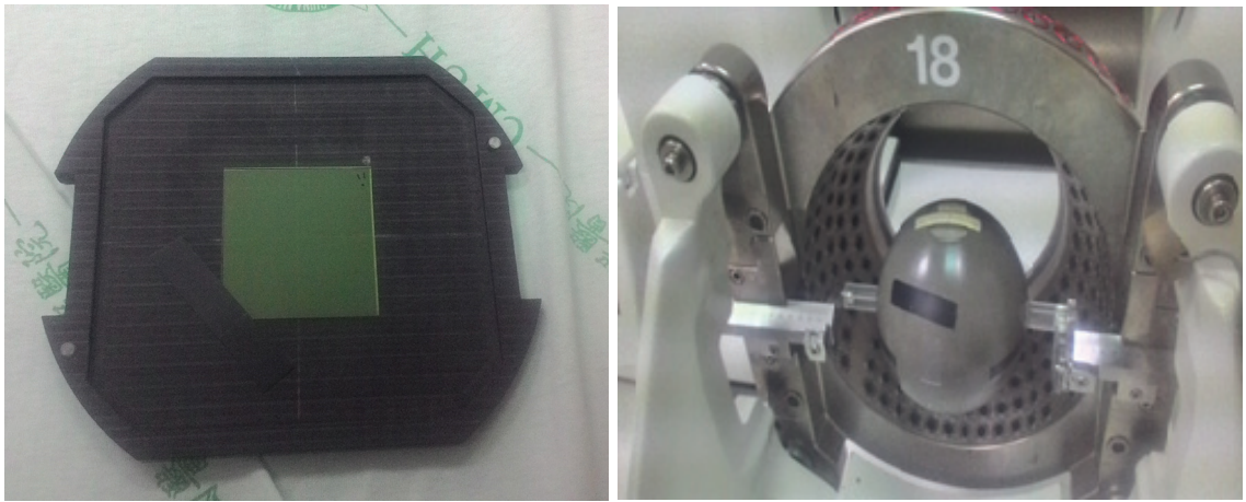
圖五、加馬刀校正膠片固定於放置於黑色碳纖維板（左），之後放入圓球形假體中（右）。
