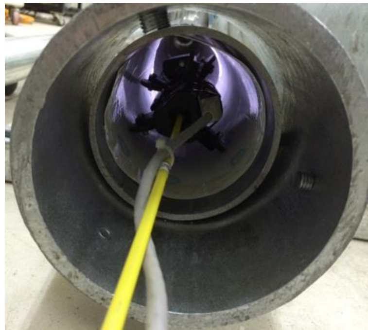
圖 63 手動式機器人污染偵檢器置管內中心量測
