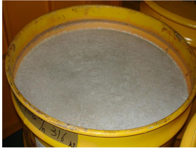
圖 14 整桶水泥(充填率 100%)
