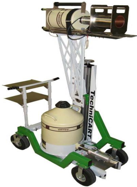
圖 40 ORTEC-ISOCAR 移動型廢棄物活度量測系統
