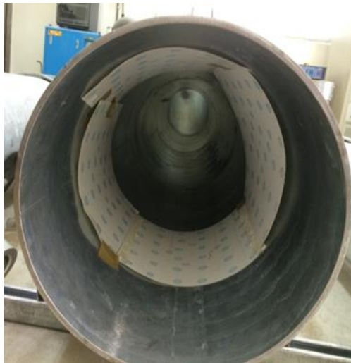
圖 62Co-60 射線覆蓋 10 吋、12 吋、16 吋管路內徑
