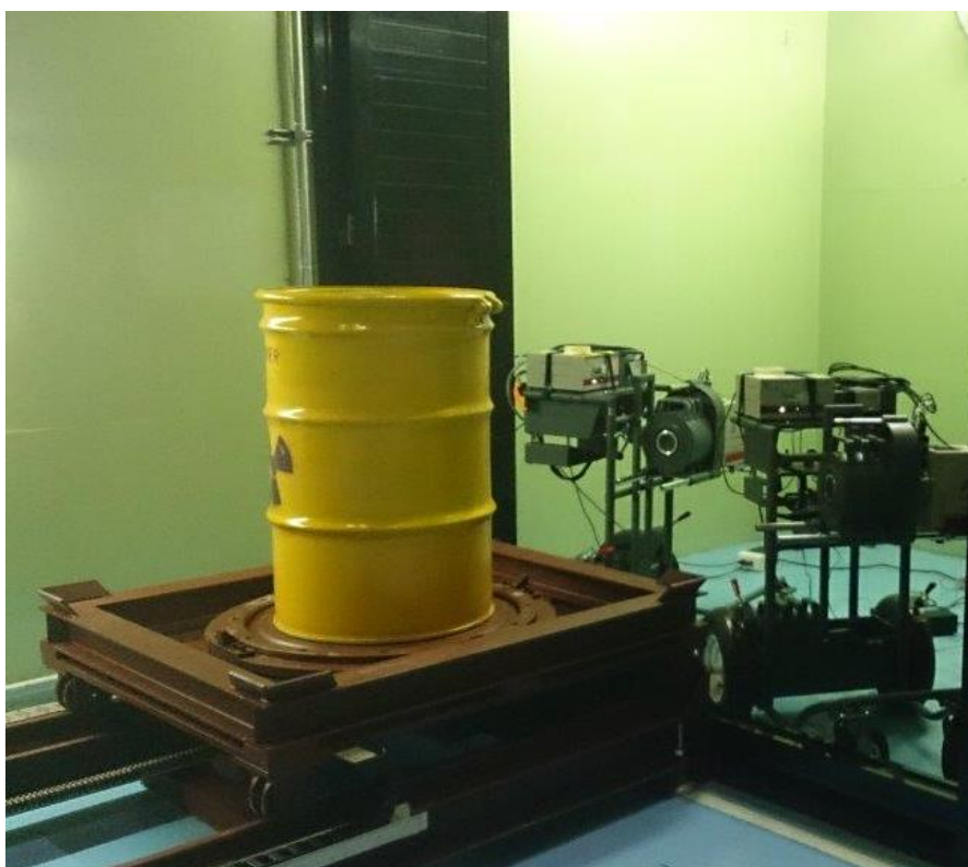
圖 7 代碼 A 及代碼 D 移動式量測系統
