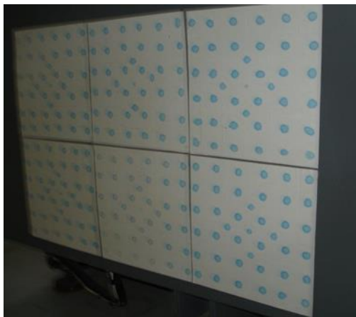
圖 55 片射源置 18 cm 厚鉛材牆面( 11.3\text{gcm}^2 )
