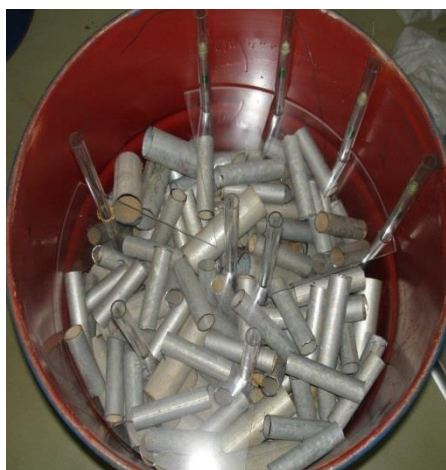
圖 18 金屬桶內射源棒放置偏單邊或集中中心位置
