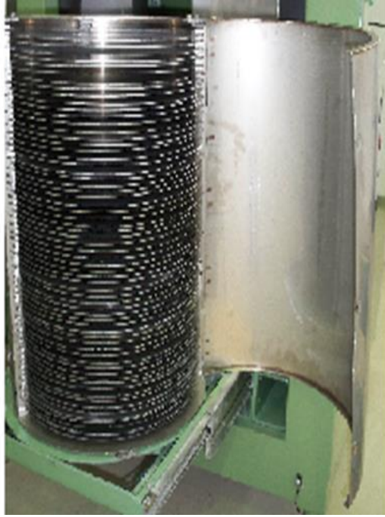
圖 29 桶型金屬片組合校正假體
