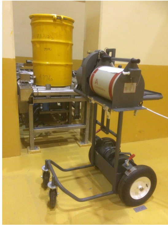
圖 8 代碼 B 固定式量測系統及輸送帶
