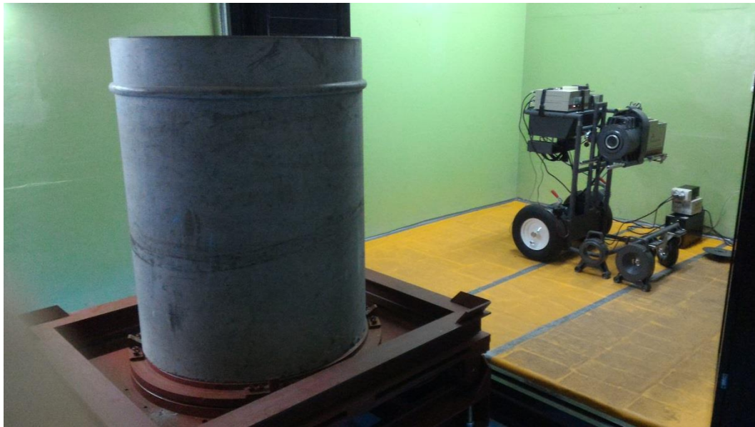
圖 34 高密度混凝土桶內置廢棄物桶
