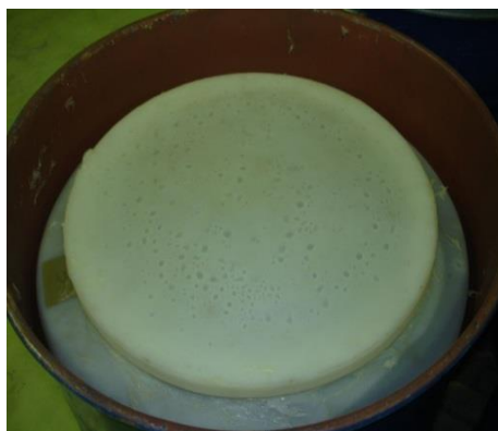
圖 12 整桶樹脂(充填率 96 %)
