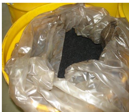
圖 13 整桶過濾器活性炭(充填率 90 %)
