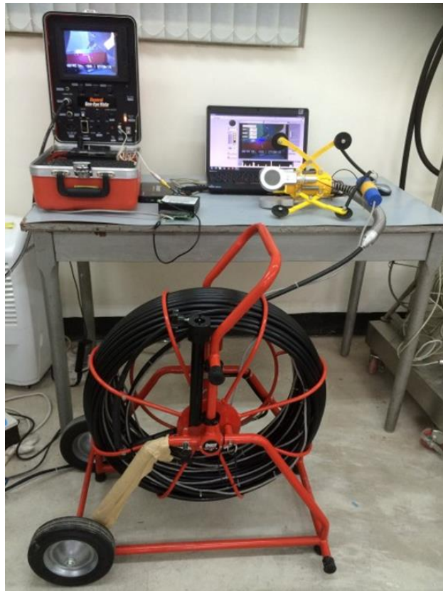
56INER-LN7231 圓餅型蓋革偵檢器與手動式電纜
