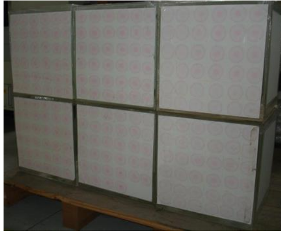
圖 53 片射源置 34cm 厚水溶液牆面
