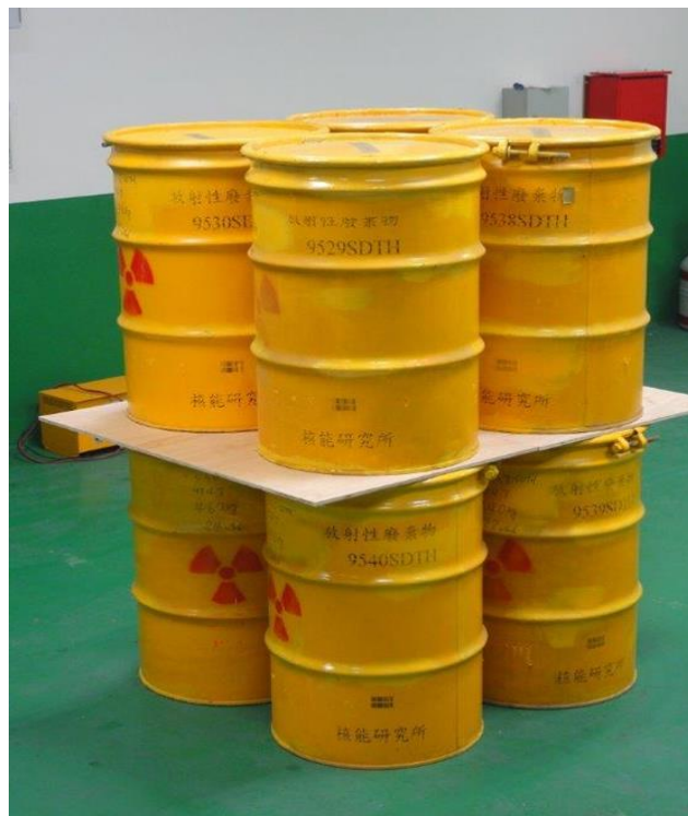
圖 51 積木堆積直立形水泥校正體
