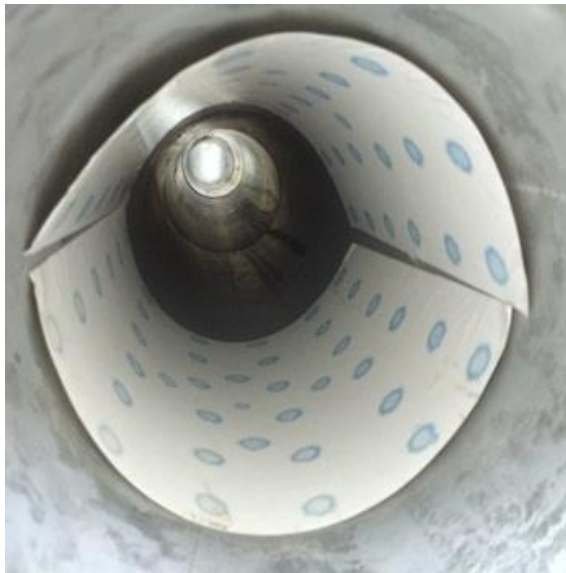
圖 61Co-60 射線覆蓋 4 吋、6 吋、8 吋管路內徑
