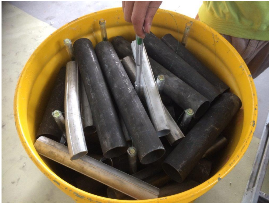
圖 33 鐵管中置 9 支棒狀射源之廢棄物桶
