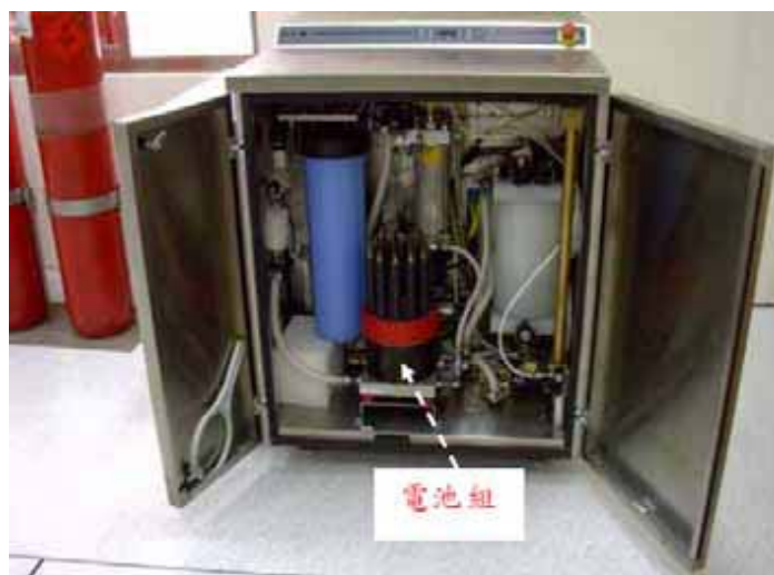
圖 47 薄膜式水電解產氫器內部組件配置
