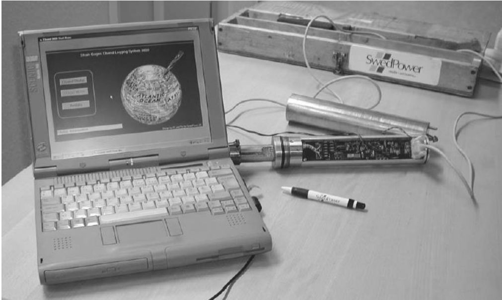
圖E-6 Borre 探頭及搭配之資料擷取系統(Sjoberg & Klasson, 2003)
