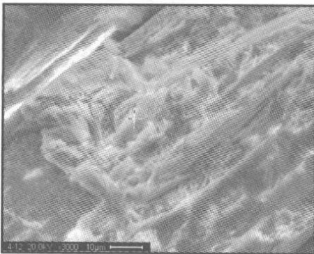
圖 4.20 試驗前後之破裂面表面礦物形貌比對(申林方等人, 2010)
