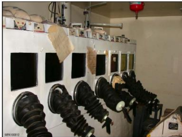
圖 3 其他廢棄物（手套箱）示意圖 (USDOC, 2016)
