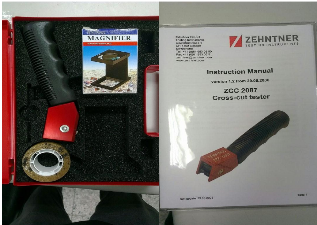
圖 10 百格試驗儀器圖
