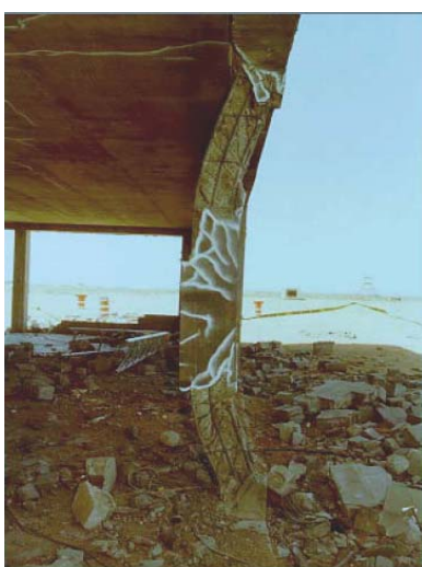
圖 1.3.2 爆炸荷載作用下 CFRP 補強柱與未補強柱之破壞型態[28]
