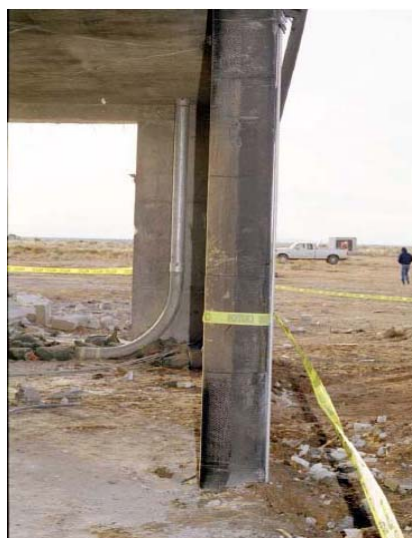
圖 1.3.2 爆炸荷載作用下 CFRP 補強柱與未補強柱之破壞型態[28]
