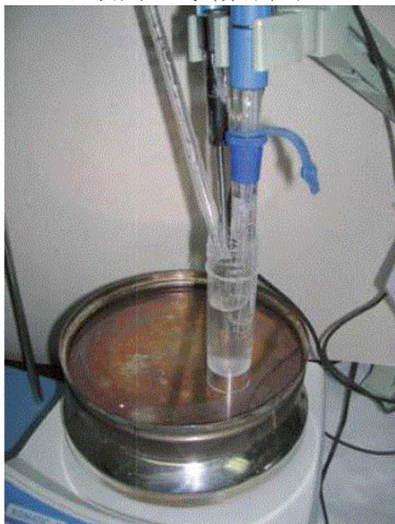
圖 4.3 孔隙溶液在惰性氣體環境下量測 pH 值
