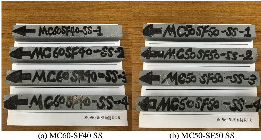
圖 4.50 砂漿乾燥及自體收縮試體照片
