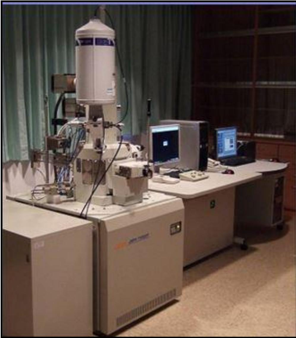
圖 3.15 掃描式電子顯微鏡
