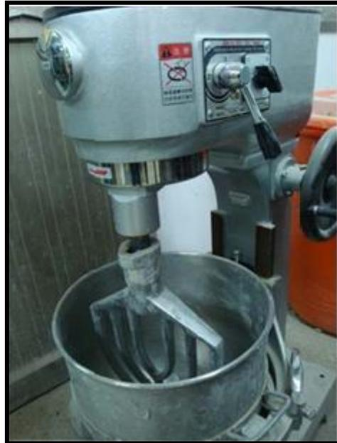
圖 3.11 三段式攪拌機
