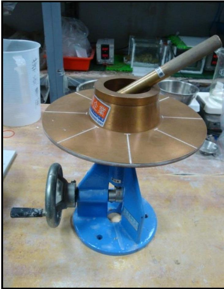
圖 3.3 水泥砂漿流動台
