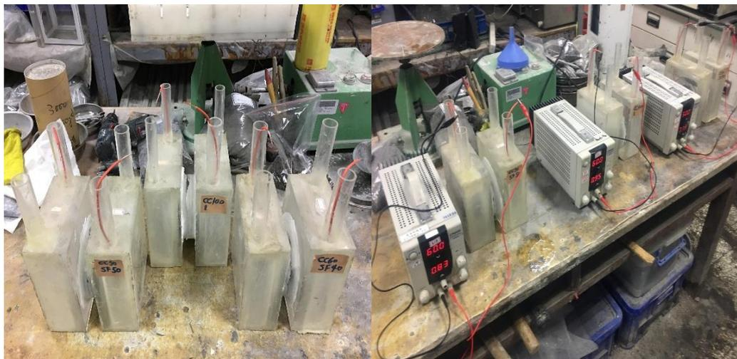
圖 4.60 快速氯離子滲透試驗設計
