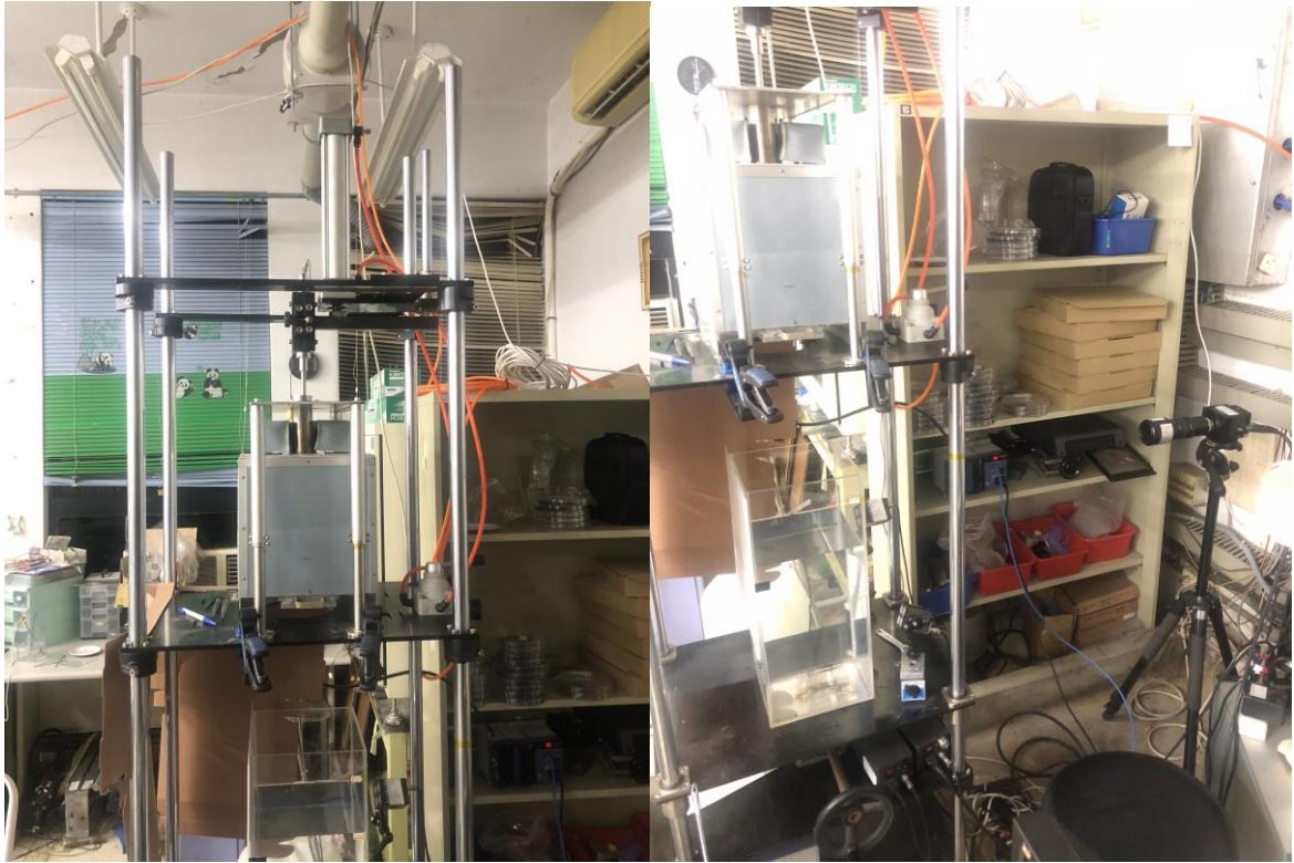
圖 3.4.4.2 實驗架設圖(左圖為加熱爐、汽缸等；右圖為淬冷槽、高速攝影機等)
