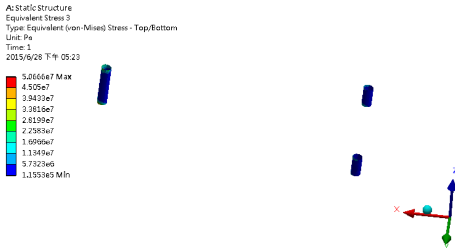
圖 10、導柱結構應力分布
