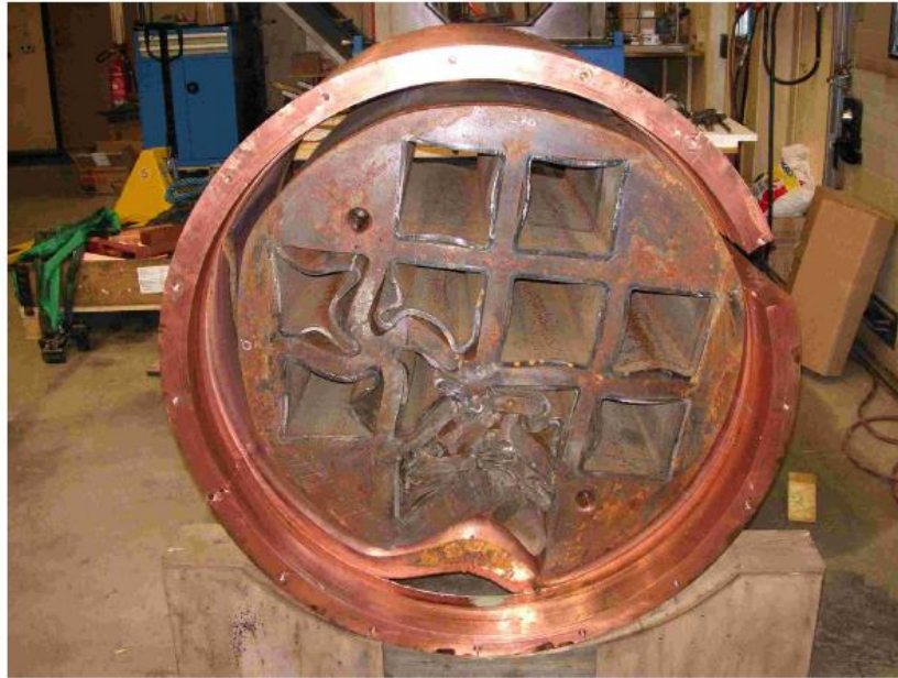
圖 4.4 廢棄物罐承受 138MPa 靜壓力之破壞狀況示意圖
