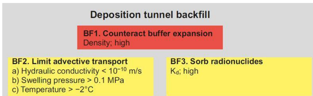
資料來源：SSM Technical Note 2012:42 圖 4.17 SKB 定義之回填區安全功能(TR-11-01)
