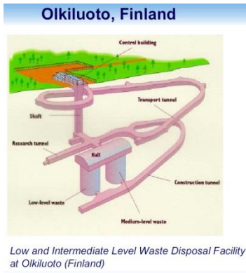
坑道處置示意圖-芬蘭 Olkiluoto
