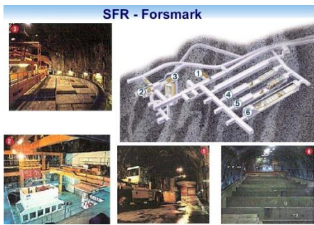
坑道處置示意圖-瑞典 SFR
