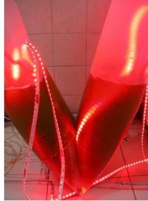
圖三十三、*Synechococcus* sp. PCC7942 培養於 50 L V 型槽光反應器
