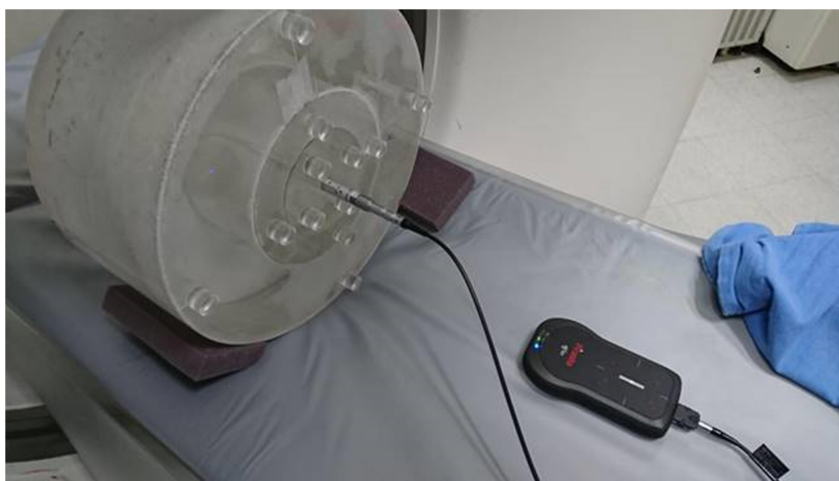
圖 2、電腦斷層掃描儀專用固態偵檢器(CT Dose Profiler, RTI)
