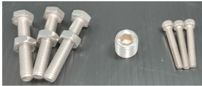
圖 3-8 螺桿、螺帽、不鏽鋼塞與可變裂隙螺絲
