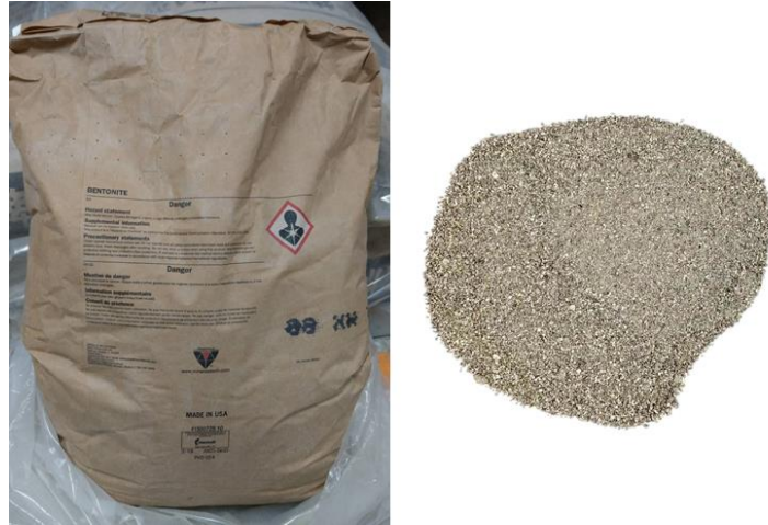
圖 3-2 (a) MX-80 產品包裝；(b)土樣顆粒外觀
