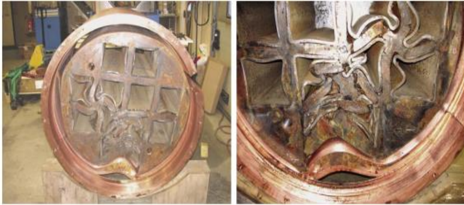
圖 4-15 SKB 試驗罐體受壓變形圖[12]
